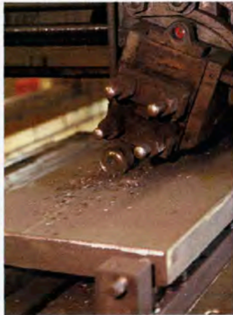
Gjutjärnsborden räfflas och blir helt plana i hyveln.
